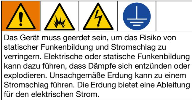
Das **Reactor**-Gerät wird über das Netzkabel geerdet.
